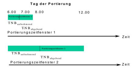
Um Kreisrouting zu verhindern ist festgelegt, dass im ersten Teil der aufnehmende TNB seine Maßnahmen (Prozessschritt 15) durchführt und im zweiten Teil der abgebende Netzbetreiber (Prozessschritte 16).
